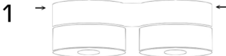
Lösen Sie die Schrauben an den Seiten um die Halterung von der Leuchte zu trennen.
